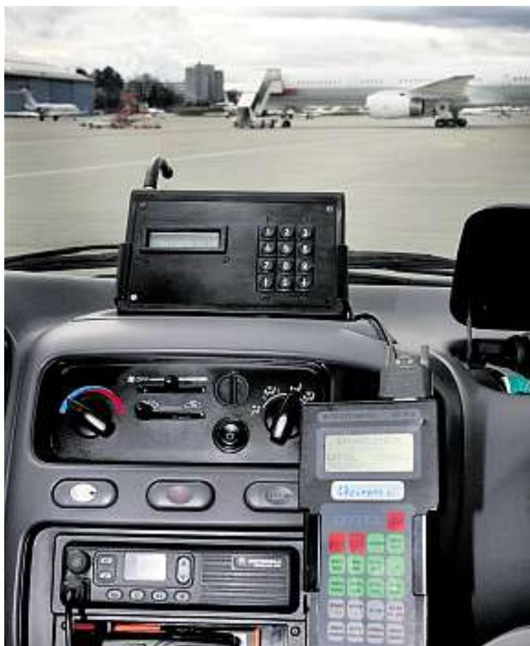
Le véhicule de patrouille est équipé d'un appareil diffusant des sons qui effraient les oiseaux.
