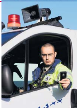
Pour effaroucher oiseaux et animaux, Tristan Hofmann a plusieurs moyens à disposition: la diffusion de cris préenregistrés, le générateur de bruit sans oublier le fusil laser.
